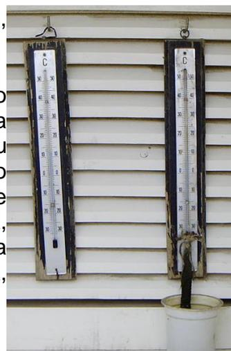
O termómetro seco, como é um termómetro sensível, indica-nos a temperatura real do ar no momento da observação e refere-se sempre à temperatura à sombra e sob as condições do abrigo.
