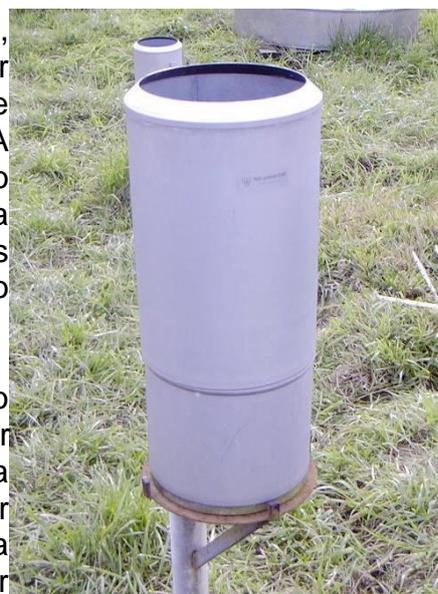
Udómetro da Estação Agro-meteorológica da ESC
